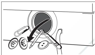
6. Удалите посторонние предметы и ворс из корпуса и с крыльчатки насоса.
