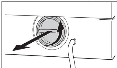
5. Когда вода перестанет литься, отвинтите против часовой стрелки крышку насоса (A) и извлеките фильтр. При необходимости используйте плоскогубцы.
